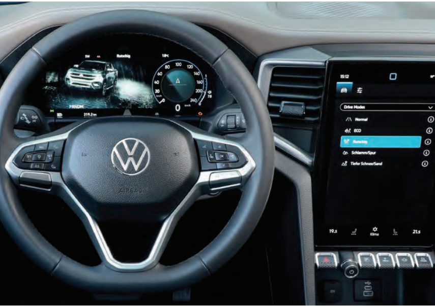
Ένδειξη Drive Mode «Ολισθηρό» στην οθόνη Infotainment και Drive Mode-Animation στο Digital Cockpit.
