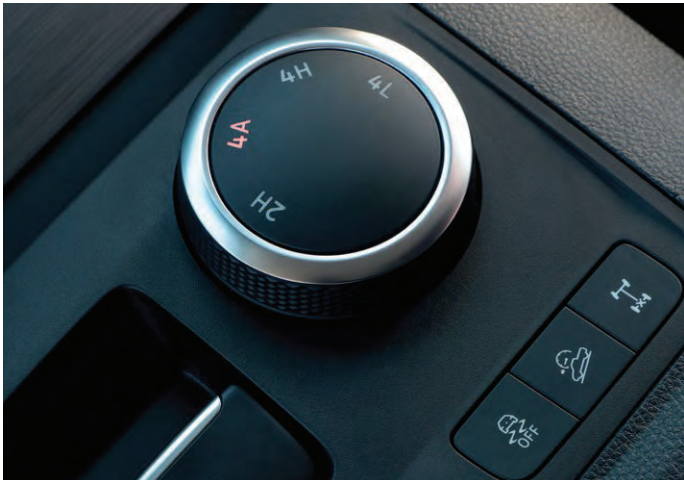
Επιλογέας για επιλεκτική τετρακίνηση 4MOTION και πλήκτρο για μπλοκάρισμα διαφορικού (δεξιά) στην κεντρική κονσόλα.
