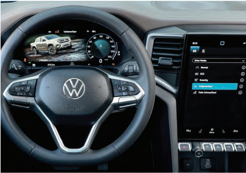
Ένδειξη Drive Mode «Λάσπη/αυλάκι» στην οθόνη Infotainment και Drive Mode-Animation στο Digital Cockpit.
